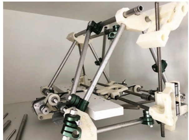
Figura 4. Exemplo de uma impressora 3D criada pelo autor com base em barras de fixadores externos e peças plásticas impressas por outra impressora – capacidade de autorreplicação da tecnologia.
